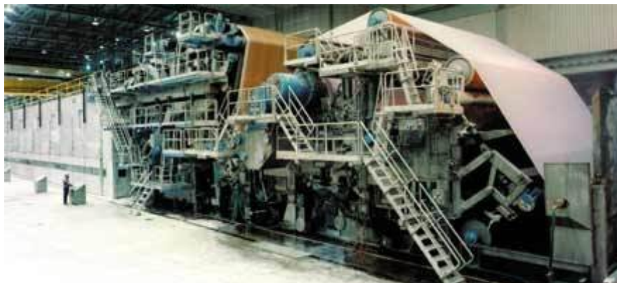
Machine de l'usine Kruger (Trois-Rivières, Québec). Cette machine produit 205 000 tonnes de papier journal par an.
