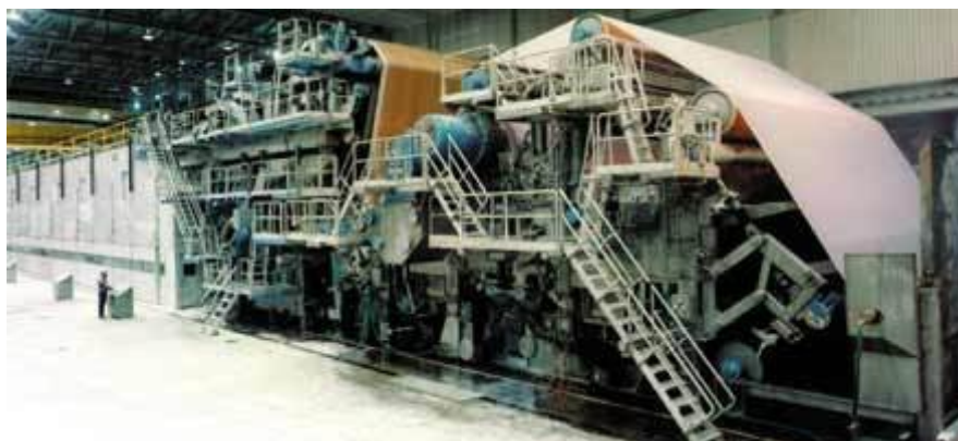
Machine de l'usine Kruger (Trois-Rivières, Québec). Cette machine produit 205 000 tonnes de papier journal par an.
